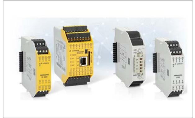
más estrictos. El innovador micro PLC de seguridad samos PRO Compact de Wieland Electric (ampliable modularmente), con protocolos de comunicación por Ethernet industrial integrados, permite conectar con seguridad y fiabilidad sensores digitales y analógicos. Gracias al software gratis samos PLAN 6 esto se logra sin saber programación.
