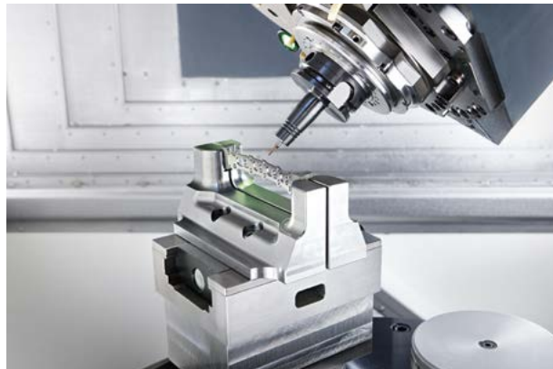
El esbelto portaherramientas de expansión hidráulica TENDO Slim 4ax puede sustituir a los portaherramientas termorretráctiles 1:1 gracias a la geometría exterior estandarizada sin necesidad de reprogramación.
