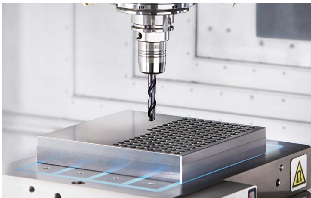
Los portaherramientas como TENDO Silver son ideales para iniciarse en el mundo de la tecnología de expansión hidráulica. Este todoterreno de precisión es compatible con todos los husillos de máquinas herramienta.
