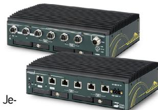
Accionado por NVIDIA Jetson AGX OrinT SoM incluido con JetPack 5.0.2 -2x 2,5 Gigabit Ethernet + 4x puertos PoE+ Gigabit IEEE 802.3at -2x bandejas de disco duro de 2,5" de acceso frontal -1x zócalo de llave M.2 2280 M para SSD NVMe -2 conectores mini-PCIe para módulos WiFi/ GNSS/ NVMe/ CAN -1x conector M.2 B 3042/ 3052 para comunicaciones móviles 4G/5G -1 puerto RS-485 aislado y 2 puertos RS232 -entrada de CC de amplio rango de 8 V a 48 V con control de encendido integrado.
