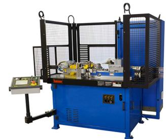
Las recortadoras-bordonadoras Vbu pueden realizar con simplicidad y rapidez los trabajos más variados en chapa plana o embutida, de sección circular o poligonal.
