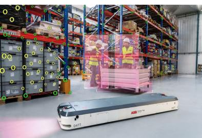
Cada robot móvil, equipado con visión e IA, escanea una parte única de la planta; en conjunto, estos robots complementan la visión de los demás para formar un mapa completo, lo que les permite trabajar de forma autónoma en un entorno que cambia rápidamente".
