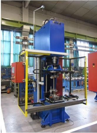
AGME desarrolla proyectos llave en mano para el ensamblaje de subconjuntos de compresores industriales utilizando la tecnología de prensado.
