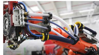
Con el sistema Sumoslid de Sumcab, el suministro de materiales o las mangueras de succión se guían del brazo robótico a través del patín de retracción móvil que se desplaza hacia delante y hacia atrás según el movimiento de la muñeca – eje 6 del robot. El patín compensa los cambios necesarios en la longitud de las mangueras según lo requerido mediante una retracción del resorte y evita torceduras, así como golpes en el brazo del robot.
