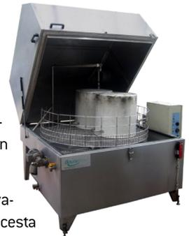
Las máquinas LIK-R de Bauermic, S.A, permiten lavar, desengrasar y enjuagar piezas de diferentes dimensiones y con un alto grado de suciedad.
