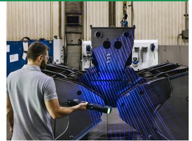
Creaform anuncia la incorporación a la línea HandySCAN 3D, la serie MAX. La línea de escáneres 3D industriales portátiles de la serie MAX, diseñada y fabricada en Canadá, ofrece una impresionante área de escaneo 3D de aproximadamente 1 m x 1 m y fue desarrollada para adquirir mediciones 3D exactas de cualquier superficie grande y compleja.
