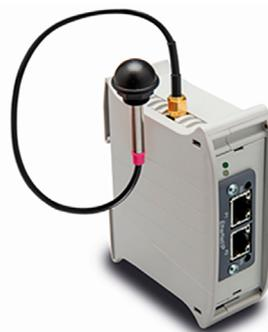
El sistema consta de un total de 36 indicadores de posición electrónicos conectados por radiofrecuencia a una unidad de control externa.
