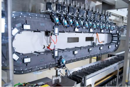
mientras están en constante movimiento a alta velocidad. El uso de cables no era una opción para una tarea tan compleja y de alta velocidad, ni tampoco las soluciones inalámbricas convencionales. Con el uso de productos basados en IO-Link Wireless de Core-
