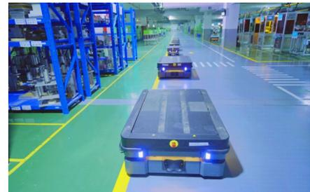
Los doce robots de la flota operan de forma colaborativa dentro de tres grupos distintos, cada uno dotado de funciones especializadas. Estos grupos incluyen robots que permiten elevar piezas de montaje de la estantería al carro, recoger productos acabados y vaciar los palés de entrega. Los tres grupos de robots se coordinan a la perfección a través de un software de gestión de flotas, MiR Fleet, y el sistema de control de robots RCS3.0.
