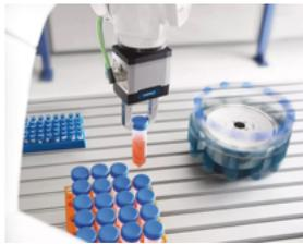
Schunk ha desarrollado una pinza versátil para piezas pequeñas para la manipulación de piezas delicadas y frágiles. La pinza inteligente EGK demuestra su fuerza en las complejas y variadas tareas de la industria de los laboratorios o de la fabricación de productos electrónicos.
