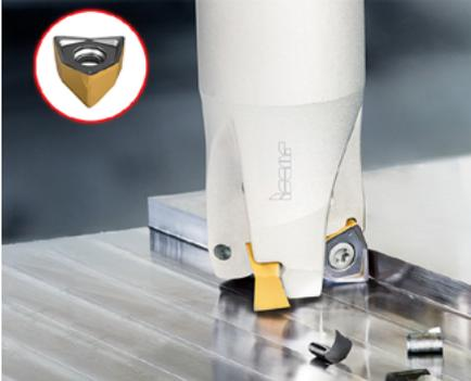
Plaquitas Triangulares con Filos de Corte de 4mm. Gama de plaquitas H690-04. Solución económica para escuadrado a 90°. Plaquitas con radio de punta de 0.8 mm y calidades de metal duro CVD y PVD para satisfacer los crecientes requisitos de diferentes sectores industriales, de operaciones de fresado eficientes y productivas:
