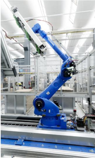
Yaskawa ofrece una solución técnica para la recuperación de la energía de frenado del robot a la red eléctrica, de forma estándar y sin hardware adicional.
