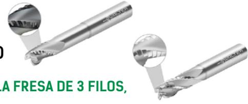
Con la MD265 Supreme y la MC268 Advance, Walter amplía su gama de fresas MDI para el mecanizado ISO N con dos especialistas en desbaste diferenciados. La fresa de tres filos MD265 Supreme (diámetro 16-25 mm), disponible con y sin recubrimiento, se caracteriza por sus canales de refrigeración en forma de estrella y sus robustos filos de corte con perfil Rapax. Fue diseñada para conseguir una alta productividad y seguridad de proceso, por ejemplo, en la industria de automoción.
