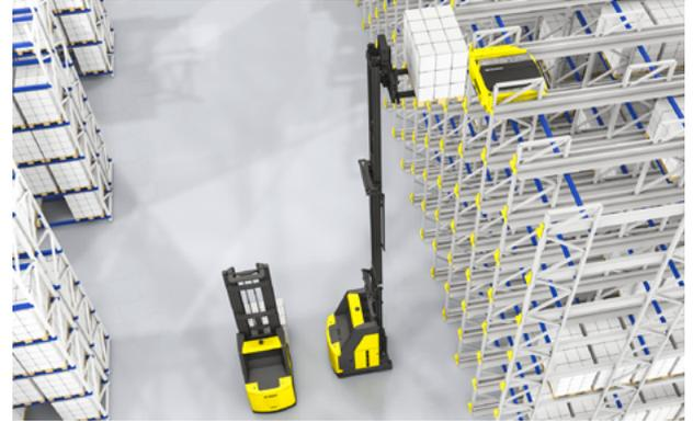
SSI Schaefer ofrece una solución en forma de una combinación inteligente de almacenamiento de palets en canales que ahorra espacio con el shuttle SSI Orbiter y vehículos de guiado automático (AGV), una solución que también proporciona una entrada gradual en la automatización.
