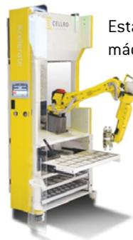
Está diseñado para cargar piezas de trabajo en una sola máquina: El robot de Cellro permite el acabado automático de series de producción. Cuenta con un sistema de carga automática apto para su vinculación a máquinas CNC. Además, Xcelerate X10 tiene la capacidad de continuar operando de manera automática después del tiempo de cierre. Automatización flexible:
