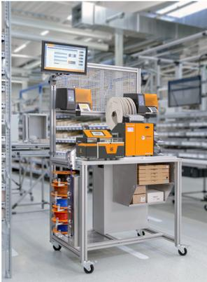
El Wire Processing Center de Weidmüller (WPC) se encarga del cableado y montaje mecánico en la fase de instalación. La composición de cables semiautomatizada y controlada mediante software acelera considerablemente los procesos de fabricación y, al mismo tiempo, garantiza los estándares de calidad más elevados.
