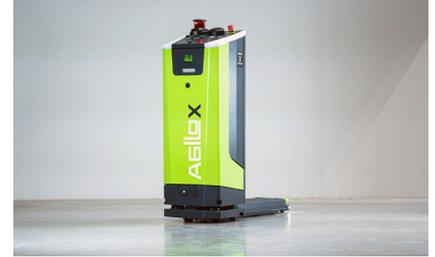
Esto quiere decir que puede asumir cargas con un peso máximo de 300 kg hasta una altura máxima de elevación de 250 mm y transportarlas hasta su destino. El concepto del AMR inteligente con la tecnología Agilox X-Swarm accede, así, a campos de aplicación y a otros sectores industriales porque los transportadores de pequeñas cargas como, por ejemplo, bolsas, para las que está diseñada la Agilox ODM, se utilizan ampliamente sobre todo en las industrias de electrónica y farmacéutica.
