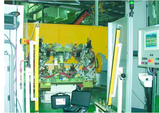
El tiempo de parada es el que transcurre desde el instante que se corta el haz luminoso del dispositivo de protección opto - electrónico activo hasta que el movimiento peligroso se detiene. Este tiempo es la suma de todos los tiempos que intervienen en la función de parada:
