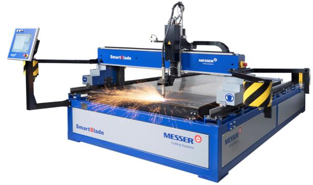
Global Control, una mesa de corte integrada. Además, SmartBlade proporciona la máxima superficie de corte en el mínimo espacio, una alta precisión gracias a los ejes longitudinales dobles, así como la minimización de los daños en la antorcha debido a la detección de colisiones y al soporte magnético
