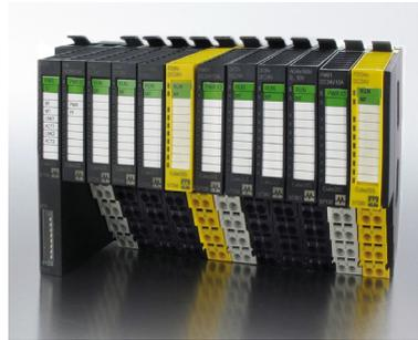
El sistema modular de bus de campo Cube20S de Murrelektronik amplía la familia Cube con series extremadamente útiles, con el mismo diseño compacto y flexible, característico de los módulos Cube. Las reducidas dimensiones de los módulos (12,9 mm de ancho) ahorran espacio y ofrecen un diseño modular que asegura una conexión rápida y sencilla gracias a la placa base integrada de alimentación.
