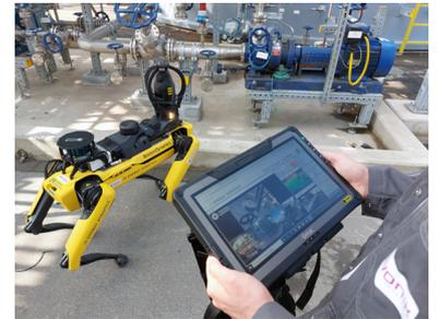
En el marco de un proyecto de innovación y en colaboración con tres socios, Evonik, realiza trabajos de mantenimiento e inspección en zonas críticas de las plantas mediante el uso de un robot autónomo con el objetivo de evaluar la utilidad de una solución robótica automatizada para el mantenimiento y la inspección en la industria química.
