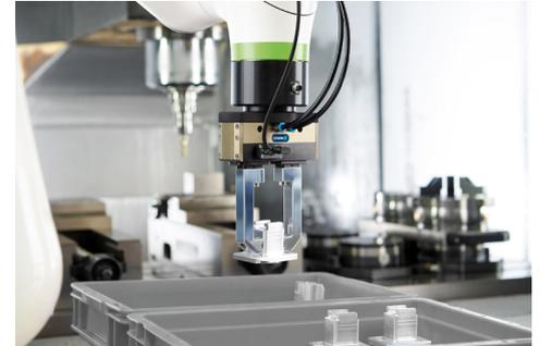
Con la PGL-plus-P, Schunk presenta un equipo potente flexible y robusto que destaca sobre todo por su mayor seguridad. La pinza neumática cuenta con el mantenimiento de la fuerza de agarre seguro y certificado.
