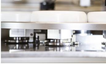
Nexen Group, Inc. destaca como proveedor de embragues de fricción para los servomotores de una mesa de indexación rotativa de ocho etapas para el mecanizado específico de piezas.
