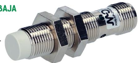
La salida es un contacto normalmente abierto PNP con una frecuencia de 2 kHz. Con una distancia de conmutación de 4 mm con montaje no enrasado, el sensor inductivo AM6/AP-2HA24 se puede utilizar en un rango de temperatura de -25E70 °C.
