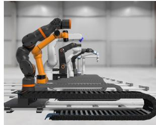
Los brazos robóticos articulados pueden desplazarse hasta más de seis metros y cuadruplicar su espacio de trabajo con el 7º eje de igus, que es compatible con todos los robots ligeros gracias a un sencillo kit "Plug & Play". Grandes fabricantes y la serie robotlink de igus ya se han beneficiado de este incremento en la movilidad.
