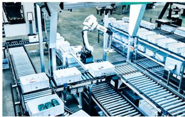
Unidades de agarre distintas, la detección inteligente de objetos basada en IA y el cálculo del punto de agarre permiten el manejo de una amplia gama de artículos y el empleo en distintos sectores. Incluso con mercancía de superficie reflectante, Pick-it-Easy Robot determina la forma exacta de agarre de la mercancía para posicionarla de forma segura en su destino. El aprendizaje de máquinas se encarga de un sistema en constante aprendizaje y mejora.
