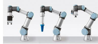
El kit de pinzas de sujeción está compuesto por tres modelos distintos, tanto paralela como por compresión y succión de vacío: la pinza eléctrica estándar EHPs, la pinza adaptativa DHEF y el generador de vacío OVEL. Con las tres pinzas, se pueden cubrir todas las necesidades de pick & place de un proceso productivo automatizado.
