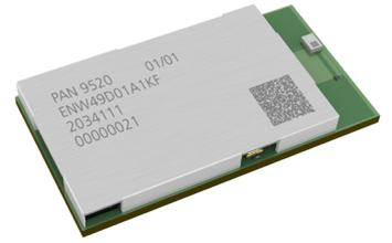
AVNET Abacus anuncia la disponibilidad del módulo Wi-Fi embebido 802.11 b/g/n de 2,4 GHz PAN9520 de Panasonic, que soporta anchos de banda de 20 y 40 MHz, con velocidades de datos de hasta 150 Mbps.
