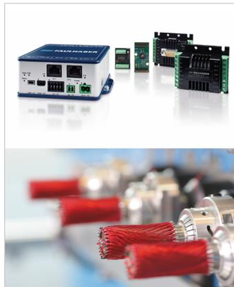
ejemplo, procesos rápidos de posicionamiento. La corriente también está limitada antes de que el bobinado se sobrecaliente. Los parámetros necesarios se transmiten oportunamente al controlador de accionamiento mediante el "diálogo de selección de motor" del Motion Manager de Faulhaber.
