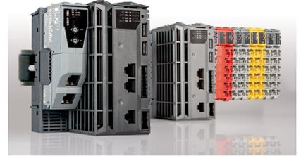
Con sus potentes procesadores Intel Atom, los PLC también resultan adecuados para aplicaciones exigentes con tiempos de ciclo cortos. Los dispositivos compactos pueden incluso controlar una aplicación robótica plenamente operativa. Los fabricantes de máquinas ahorran tanto costes como espacio en los armarios.
