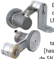
El sistema de medición de distancia LMSCA permite un ajuste preciso de la fuerza de contacto con el material (hasta 20N en pasos de 5N). El muelle en espiral asegura que la presión de contacto sea tan alta como se requiera para evitar posibles deslizamientos.
