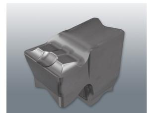
En comparación con las plaquetas existentes con rompevirutas tipo 'P', las plaquetas ofrecen un mejor resultado en la formación de virutas cuando se aplican bajos avances, 0,06 mm/v en aceros al carbono y 0,08 mm/v en aceros aleados.
