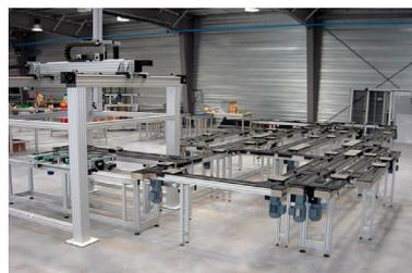
TLM es un sistema de transferencia modular de paletas con componentes totalmente estándar, que permite construir líneas de manipulación y/o montaje de una forma fácil y fiable, flexibilizando el tiempo de diseño y de montaje y por tanto, reduciendo el tiempo de estudio y su realización.
