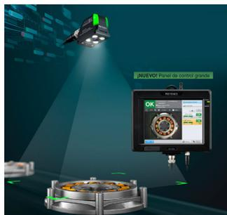
Bitmakers ofrece el IV2, un sensor de visión con IA que resuelve las aplicaciones sin tener que programar el equipo. Para realizar una aplicación se presenta una pieza buena y otra mala, el IV2 se autoconfigura.
