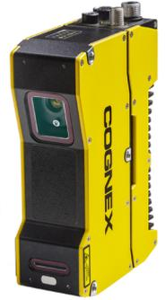
La cámara 3D-L4000 combina la óptica patentada del láser azul sin moteado y la gama más amplia de herramientas de visión 3D reales con la flexibilidad de la hoja de cálculo In-Sight. Esta solución "todo en uno" captura y procesa rápidamente imágenes en 3D con una calidad espectacular durante las aplicaciones de inspección en línea, guiado y calibrado.
