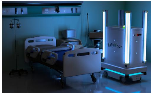
SafeRbot, es una solución de desinfección móvil por radiación ultravioleta (UV-C) capaz de desplazarse de forma autónoma, eliminando virus, bacterias y otros patógenos, cumpliendo con el requisito de seguridad para dispositivos UV-C (Norma UNE 0068), utilizados para la desinfección de aire de locales y superficies.
