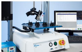
La serie R de Nordson EFD logra una repetibilidad de  $\pm 0,008$  mm y software a medida para facilitar la configuración y programación de la dosis.
