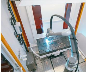
Omron, compañía líder en soluciones de automatización industrial, y AWL, constructor de maquinaria de alta tecnología, han unido fuerzas para lanzar Qube, una celda de soldadura que incorpora tecnología de robótica colaborativa flexible. Esta celda permite automatizar la soldadura de lotes pequeños, incluyendo productos con facilidad, permitiendo a su vez una colaboración segura entre personas y máquinas.
