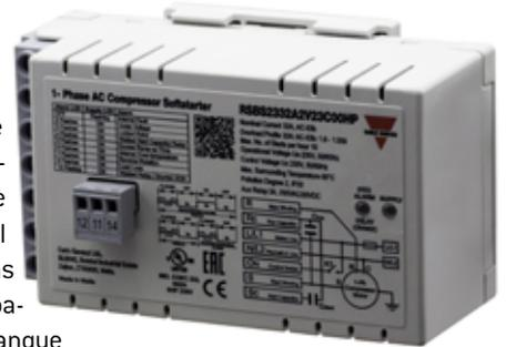
El algoritmo de control detecta automáticamente cuando el compresor alcanza la velocidad máxima para asegurarse de que el relé de bypass interno se activa cuando la corriente está en un nivel óptimo. Una función especial asegura que el compresor obtenga suficiente par de arranque incluso cuando las presiones en el arranque no están igualadas.
