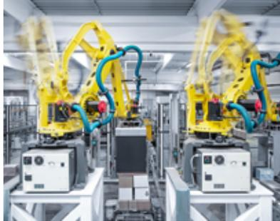
Las soluciones de full case picking están diseñadas para la creación automática de paletas mixtas.
