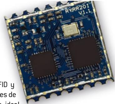
Anatronic presenta el módulo RFID y NFC de 13,56 MHz para aplicaciones de proximidad, RYRR201 que resulta ideal para un gran número de aplicaciones de identificación de proximidad, como por ejemplo control de accesos, identificación digital, control horario, etc.
