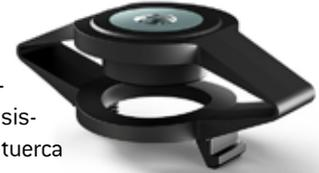
Una de sus ventajas es que la compensación de tolerancias se produce ya durante la colocación: el marco de plástico se comprime y se adapta automáticamente a la medida requerida, sin necesitar ningún otro ajuste. Gracias a su geometría, el elemento de fijación se puede montar previamente y no se desmonta durante el transporte. Este sistema de compensación de tolerancias es especialmente ligero y muy rentable.
