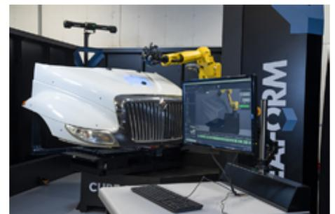
El CUBE-RT aprovecha el poder del MetraSCAN 3D-R en una célula de medición industrial de alta productividad diseñada para ser integrada a las fábricas para inspecciones en línea. En comparación con las CMM tradicionales, el CUBE-R es mucho más rápido y ofrece un aumento de la productividad y una mayor eficiencia.
