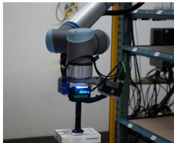
El piCOBOT de Piab es adaptable, potente y ligero. Los brazos de garra de 97-142 mm de anchura pueden inclinarse  $\pm 15$  grados, lo cual proporciona un alcance excelente para el posicionamiento de las ventosas.
