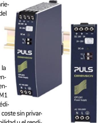
Destacan de estas fuentes su reducido tamaño y su alta eficiencia. PFC activo y limitación activa de la corriente de arranque. Esto evita cualquier consumo excesivo en la entrada que pueda disparar los magnetotérmicos. Ya no se necesita calcular cuántas fuentes se pueden poner por magnetotérmico ni usar equipos de curvas lentas C o D que son más caros. Simplemente con considerar el consumo nominal de entrada se puede saber cuántas fuentes se pueden poner en esa línea.
