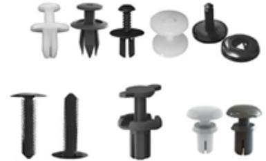
Los remaches a presión son muy fáciles de instalar y, simplemente presionando quedan bien fijados y presentan un excelente rendimiento en paneles metálicos, plásticos o de cartón. Son aptos para grosores desde 1,5 mm en adelante y están fabricados en nylon V2 y V0, polietileno y polipropileno.
