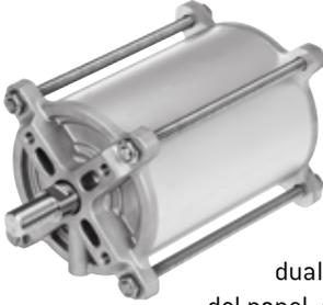
El actuador lineal neumático de doble efecto DFPC de Festo está específicamente diseñado para accionar válvulas de proceso, como por ejemplo correderas de placas/material, válvulas aprisionadoras o accesorios sin carcasa. DFPC es idóneo para las exigencias de sectores como el tratamiento de agua y aguas residuales, minería, centrales eléctricas y la industria del papel, celulosa o acero.
