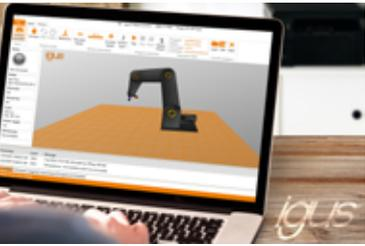
Para programar robots con facilidad, igus ha desarrollado un software de control para sus soluciones de 'Low Cost Automation'. 'igus robot control' está disponible online de forma gratuita y ofrece al usuario una introducción sencilla a la automatización. Distintas cinemáticas robóticas pueden ser programadas y controladas. Un gemelo digital simula los movimientos. De esta manera, el usuario puede programar la solución adecuada antes de adquirirla.
