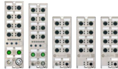
Tres bloques de concentradores IO-Link ayudan a reducir la complejidad del diseño al permitir la conexión de más dispositivos a través del maestro IO-Link. Y un conector de alimentación M12 con codificación L en bloques seleccionados admite una corriente mayor, lo que permite conectar en cadena más bloques y resulta en menores costos de cableado e instalación.
