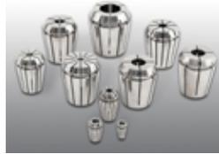
La gama de fijación de las pinzas elásticas ER11 DIN 6499 / DIN ISO 15488-B se ha reducido de 1,0 a 0,5 mm, para cumplir la norma DIN ISO 15488. Las pinzas ER11 ofrecen las siguientes ventajas: mayor rigidez, mayor precisión, mayor fuerza de apriete y repetibilidad uniforme.
