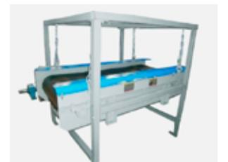
Los separadores magnéticos superiores se pueden utilizar para la recuperación (reciclaje) de partículas ferrosas, así como para la separación de partes de hierro no deseadas (contaminación por hierro).
