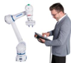
El HC10DT IP67 es resistente al polvo y al agua. Gracias a la clasificación de protección IP67, el robot de 6 ejes se puede utilizar incluso en entornos exigentes donde está expuesto a suciedad o líquidos, por ejemplo.
