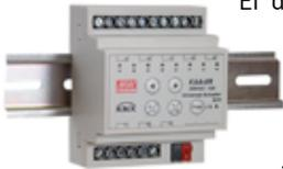
El dispositivo KAA-8R de Mean Well es un actuador binario de 8 canales y capacidad de carga de hasta 16A por canal. Su denominación "Universal" hace referencia a que cada canal puede ser configurado para diferentes aplicaciones (interruptor, minuterio de escalera, pulso, control PWM para válvula de calefacción, función de persiana, etc.).
