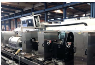
La línea de prueba ultrasónica (UT) está totalmente automatizada para detección de defectos y medición dimensional en tubos y barras.
