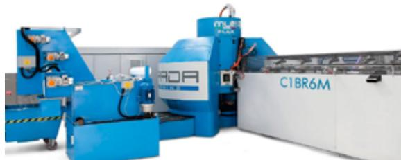
La máquina Multi-S Flex, debido a su alta flexibilidad y rapidez en el cambio de producción permite la fabricación de piezas incluso en series pequeñas y no exclusivamente para lotes grandes. La máquina Multi-S Flex está equipada, en su configuración estándar con 6 u 8 estaciones de mecanizado, cada una con husillo controlado, independiente, que permite realizar operaciones de torneado, fresado, taladrado e interpolaciones de hasta 4 ejes.
