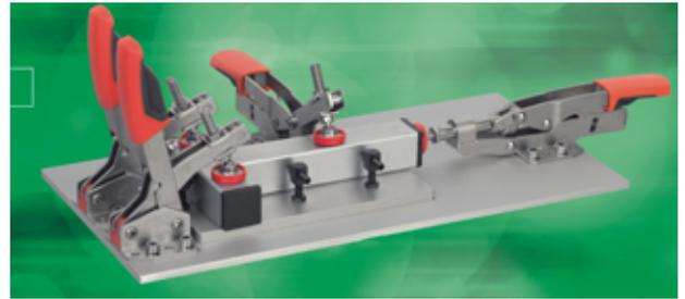
El autobloqueo está garantizado cuando se sobrepasa la posición de centro muerto (alineación de las tres articulaciones) y se puede ajustar la fuerza de sujeción convenientemente mediante el tornillo de presión.
