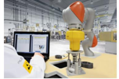
En las aplicaciones con colaboración en método 4 entre persona y robot, donde la colisión es posible, y en cumplimiento de la especificación técnica ISO/TS 15066, se requiere de la verificación que dichos impactos no superarán los límites de fuerza y presión establecidos en la norma. Para realizar dicha validación, Pilz dispone de un servicio y equipo de medición de colisiones, el Pilz Robot Measurement System (PRMS).
