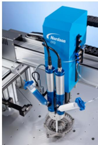
Volúmenes precisos y repetitivos de fluidos, en cantidades mínimas de hasta 0,01 ml por revolución. Las tolerancias de volumen de depósitos equivalen a +/- 1% permitiendo un alto nivel de control en los procesos en aplicaciones automotrices, electrónicas, médicas y otras producciones. El diseño del 797PCP se basa en la parte principal de cavidad progresiva donde los componentes principales (un rotor y un estator) forman una cámara de dosificación perfectamente sellada.
