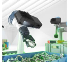
de piezas o componentes en el lugar de almacenamiento y trasladándolos hasta la línea de montaje de forma segura sin colisionar con obstáculos o personas.
