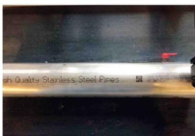
Cabezal fijo o rotativo de marcado de tinta capaz de imprimir texto y marcar hasta 30 mm. (1.18") con movimiento de rotación de  $\pm 270^\circ$  y rebobinado automático. Su dispositivo de giro servo-motorizado marca el texto en cualquier dirección y orientación de acuerdo con su posición indicada en el software. Ajusta automáticamente la elevación e incluye la detección de colisión.
