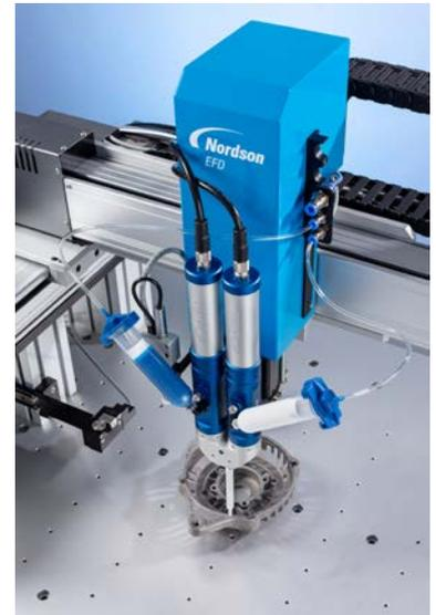
El diseño del 797PCP se basa en la parte principal de cavidad progresiva donde los componentes principales (un rotor y un estator) forman una cámara de dosificación perfectamente sellada. A medida que rota, la bomba permite realizar una dosificación volumétrica continua, sin que se vea afectada por factores externos como, entre otros, cambios en la viscosidad, fluctuación en la presión del fluido y el efecto "lleno a vacío" en jeringas.
