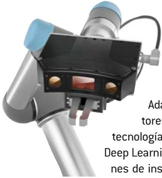
InPicker es la solución hardware (visión + robot) y software (análisis de imagen + comunicaciones) que permite identificar y definir con precisión la posición de cualquier elemento en el espacio para su posterior recolección y traslado a un punto de destino mediante un sistema robotizado.
