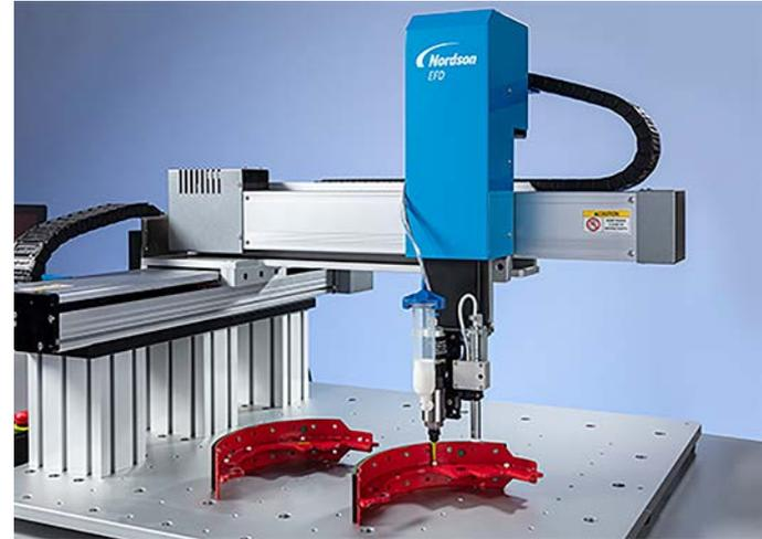
El sistema de pórtico para automatización completo tiene un software de dosificación patentado y una cámara para facilitar la configuración y programación, ideal para integrar en mesas rotativas y cadena de montaje con cinta transportadora.
