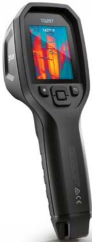
Flir Systems, Inc. ha anunciado la cámara térmica industrial Flir TG297, que ofrece medición de temperatura sin contacto y termografía para profesionales en una sola herramienta. La versátil cámara para solucionar problemas dispone de un filtro único que permite a inspectores de mantenimiento, reparaciones y operaciones identificar visualmente y encontrar el origen de muchos problemas habituales en aplicaciones de alta temperatura, como calderas, hornos, material refractario y de fabricación.
