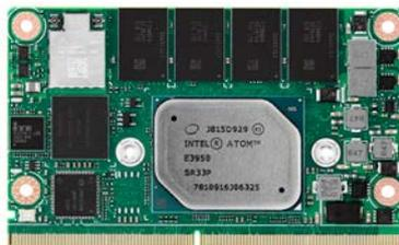
software WISE-PaaS/DeviceOn, los módulos SMARC pueden ayudar a los clientes finales a gestionar sus operaciones, además de facilitar el mantenimiento. El módulo SMARC SOM-2569 incorpora procesadores de las series Intel Atom E3900, Pentium y Celeron N. Se caracteriza por sus pequeñas dimensiones —82 x 50 mm— y admite hasta tres salidas de vídeo simultáneas. También cuenta con varias E/S, como SATA, USB3.0/2.0, puerto COM, SMBus e I2C.
