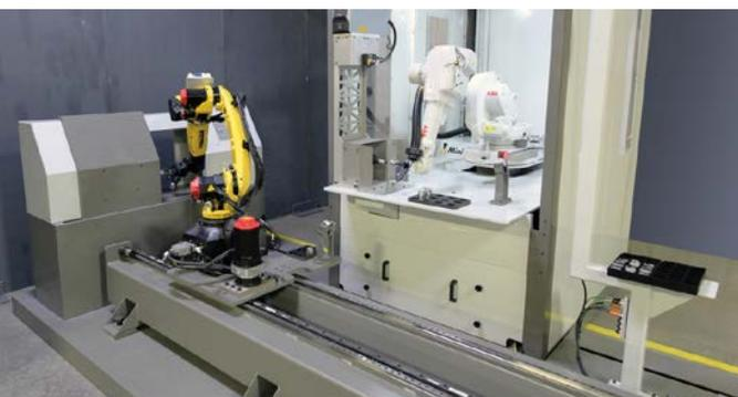
El sistema dispone de un gran área de trabajo (aprox. 1,2 x 2,4 metros) y su robusto diseño lo convierte en una solución ideal para el funcionamiento continuo (24/7) en entornos de soldadura.
