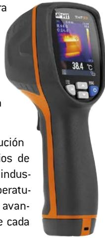
Está dotada de un sensor IR de una buena resolución (80x80pxl) lo que lo hace adecuado para usuarios de mantenimiento predictivo en cualquier instalación industrial. El modelo dispone de un amplio rango de temperatura (hasta 380°C) y la posibilidad de realizar análisis avanzados incluyendo hasta 3 puntos de medida sobre cada imagen.
