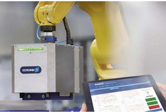
Los sistemas de agarre de Schunk facilitan la recogida y el apilamiento automatizados de los módulos celulares, los rápidos procesos de unión y la alta seguridad de procesos.
