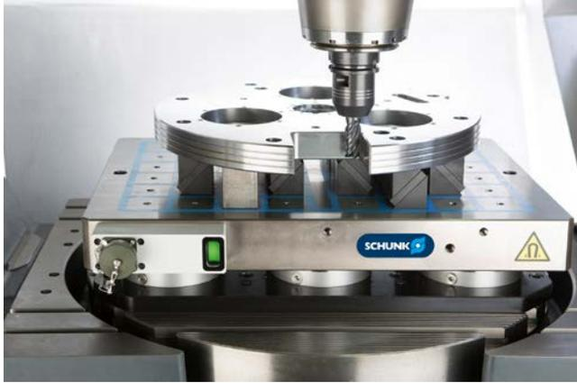
El sistema de sujeción por imán de Schunk permite mecanizar desde los 5 lados y sujetar componentes de gran volumen en cuestión de segundos. Además, en el caso de los módulos estándar permite un control visual y automatizado del proceso para evitar interrupciones.
