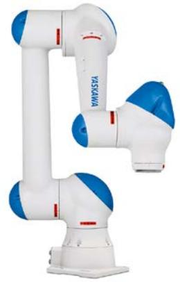
Junto con el robot HC10 se ha presentado una alfombra de seguridad que, gracias a la tarjeta de seguridad que incluye el robot (FSU), permite crear diferentes zonas de seguridad al interactuar con los operarios. Estas soluciones pueden presentarse también mediante escáner de seguridad y las tarjetas pueden aplicarse no sólo a un robot colaborativo cuando trabaja en modo no colaborativo sino también a cualquier robot de la gama Yaskawa.
