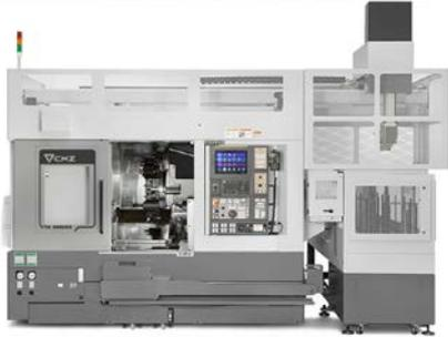
El empleo del robot Gantry, junto con los diversos tipos de apiladores de piezas, permite la automatización precisa de la carga y la descarga de piezas, conformando, con el torno, una unidad autónoma de trabajo desatendido.
