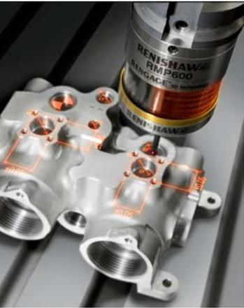
Renishaw presenta la sonda de máquina-herramienta RMP400 en combinación con la tecnología SupaTouch. La sonda RMP400 se une a la familia de sondas de máquina-herramienta RMP600, OMP400, OMP600 y MP250 de Renishaw con tecnología Rengage. Estas combinan la tecnología de galgas de esfuerzo de silicio con un sistema electrónico ultracompacto para obtener unas prestaciones y un rendimiento 3D sin precedentes por debajo de la micra. Con una capacidad superior de medición de formas y
