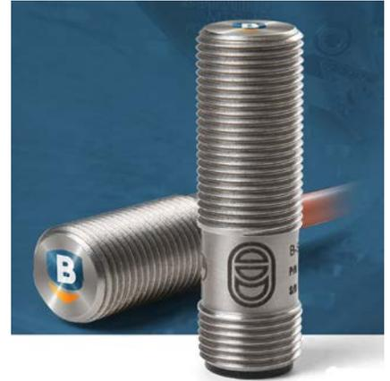
B-Safe es un sistema para el diagnóstico de husillos y máquinas-herramientas, basada en el análisis de vibraciones y temperatura. El sistema miniaturizado se puede instalar directamente en el interior del husillo, garantizando un monitorizaje en tiempo real de las anomalías, prediciendo mal funcionamiento y protegiendo su negocio al reducir los tiempos de paradas de máquina. Entre sus funciones se encuentra:
