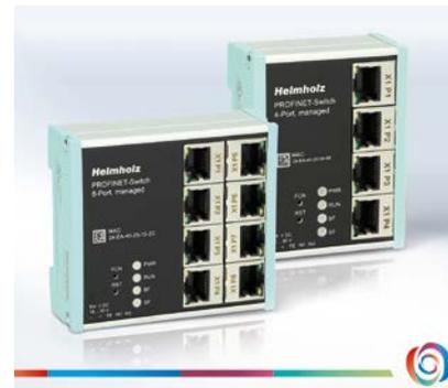
Los switches se alimentan con 24 V DC, disponen de protección IP20 y pueden utilizarse a temperaturas de trabajo de -40 a 65° C.
