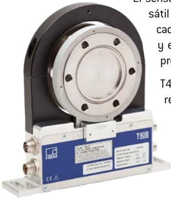
El sensor de par T40B es un elemento versátil que se adapta a toda clase de aplicaciones en bancos de pruebas: en I+D y en pruebas de fin de línea (EoL) de producción.
