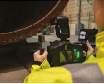
Hexagon presenta el Aicon DPA Pro Industrial que incluye la cámara C1 en combinación con el conocido sistema de medición fotogramétrico DPA. Diseñado para hacer la medición fotogramétrica más sencilla y lo suficientemente resistente para permitir un manejo inexperto en condiciones inhóspitas adversas del taller, DPA Pro Industrial está diseñado para convertirse en una de las herramientas más accesibles de alta velocidad y precisión del mercado.
