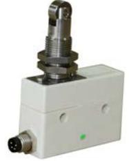
Estos microrruptores han sido concebidos para una utilización a 24 VDC en aplicaciones de automatización industrial. Permiten un control visual simple de la función de conmutación. La indicación del LED facilitará la regulación y el ajuste del punto de conmutación en el momento de la instalación sobre el terreno, lo que será muy útil, especialmente cuando el interruptor esté montado lejos del controlador conectado. Además, cualquier interrupción de la señal será identificada rápidamente.
