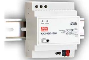
Es una fuente de alimentación con corriente de salida de 1.280 mA (30V) con una alta eficiencia y un tamaño compacto. Tiene 2 salidas, una para alimentar el bus KNX y otra salida adicional para alimentar más equipos KNX. Con un amplio rango de temperatura desde -30°C a +70°C, satisfaciendo todo tipo de aplicaciones. Incluye indicadores LED para funcionamiento normal, sobrecarga del bus y botón para resetear el carril.
