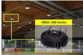
Funcionan en un amplio rango de entrada (100-305Vca) y están diseñadas con IP67 a prueba de polvo y resistencia al agua, alcanzando hasta un 94,5% de eficiencia. Incluyen protección contra sobre tensión, exceso de temperatura y corto circuito. Ofrecen un amplio rango de temperatura de trabajo desde -40 C hasta +80 C.
