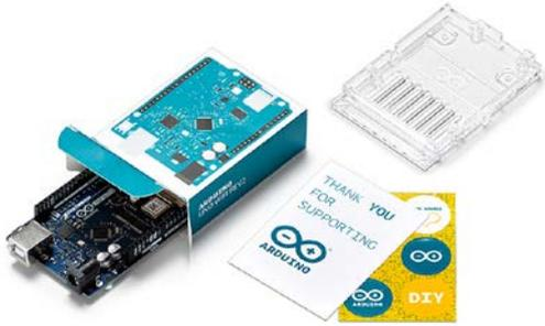
La placa de prototipado Arduino Uno WiFi Rev2 tiene mayor capacidad de procesamiento y añade seguridad para comunicaciones inalámbricas, al incorporar un microprocesador de 8 bits de Microchip.
