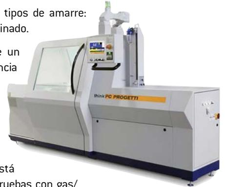
Un carenado completo antibalas está previsto para la realización de las pruebas con gas/ agua alta presión en condiciones de alta seguridad. La apertura de la puerta está condicionada por las normas de inspección visual. En la parte inferior, hay instalado un depósito de agua. Este banco está controlado por un PLC con pantalla táctil LCD. El doble control, manual y automático permite una gran flexibilidad.
