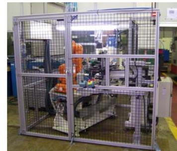
En una sola máquina esta empresa Eibarresa integra procesos de ensamblaje como: alimentación automática de cubos y tornillos, manipulación de componentes, enmangado de tornillos a cubo rueda, marcaje de piezas y aseguramiento y control de la calidad de los componentes ensamblados.
