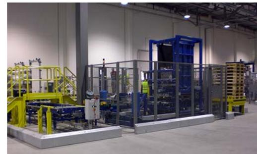
El sistema de logística garantiza un cambiador de palet muy veloz y rápido en comparación a la máquina estándar, gracias a los almacenes de palets que están dotados de transportadores para la recogida y la entrega de los palets de madera y plástico. La seguridad del sistema es garantizada a través de la utilización de un perímetro de redes metálicas y de fotocélula que reconoce hombre para el control de accesos.
