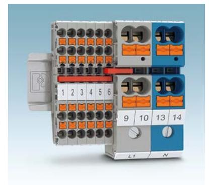
Con los puentes enchufables estándar del sistema de bornes para carril Clipline complete puede puentear los bornes PT y PTU. Se comprueba con la toma de pruebas estándar de 2,3 mm. Para cada punto de embornaje se ofrece una opción de rotulación de gran superficie.
