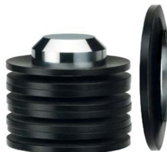
16984 (anteriormente DIN 2092), la deflexión bajo una determinada carga es predecible y se puede determinar el ciclo mínimo de vida. Los resortes/muelles de platillo pueden ser cargados estáticamente tanto continuamente como en intervalos, o dinámicamente bajo ciclos de carga continuos. Pueden ser utilizados aisladamente o en paquetes apilados en paralelo, serie o combinados.
