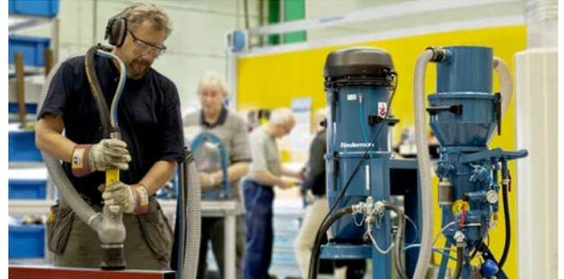
El equipo de chorreado puede ser eléctrico o neumático, modelos A418 E418 y A460 E460. La unidad de chorreado con aspiración viene completamente montada en un carro, con un separador de granalla, un silo con tamiz interno, una válvula de llenado, un generador de vacío y filtros de aire comprimido. Una válvula neumática en el silo vacía el polvo residual en una bolsa de plástico.
