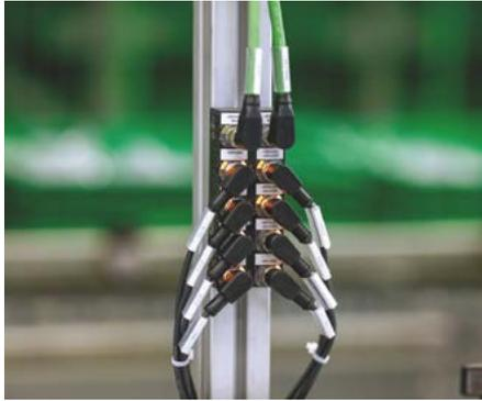
El sistema Cube de Murrelektronik es un sistema modular de bus de campo para conceptos de instalación en máquina. Su flexibilidad le convierte en la solución óptima para cualquier aplicación, con protección IP20/IP69K.
