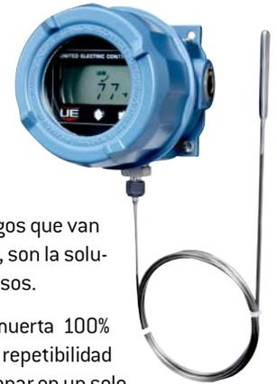
Los presostatos y termostatos serie One, con rangos que van desde vacío hasta 413 bar y desde -184 a + 538°C, son la solución para el monitoreo digital inteligente de procesos.
