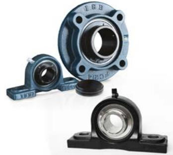
Los soportes de rodamiento de la marca ISB incluyen obturaciones a ambos lados con el fin de garantizar una perfecta estanqueidad y evitar filtraciones de polvo y líquidos. En el lado exterior cuentan además con unas "aletas" de protección que, por efecto centrífugo, garantizan la expulsión de cualquier posible elemento contaminante.
