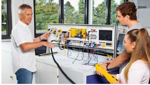
Pilz introduce esta novedad para dotar a las organizaciones interesadas en formación de una vertiente práctica. El uso de componentes industriales reales permite recrear de forma realista la maquinaria en la cual se aplica el sistema de seguridad. De esta forma, las empresas y universidades pueden programar los controles e implementar funciones seguras para conocer su funcionamiento, como el que se desarrollaría en unas instalaciones de industriales existentes.
