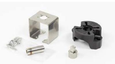
Los kits incluyen el bracket, el eje impulsor y la tornillería. Las válvulas de bola compactas (de 1/2" a 6"), de bola de doble unión (de 1/2" a 2"), de bola de 3 vías (de 1/2" a 2"), de mariposa (de 1/2" a 20") de Safi pueden ser actuadas mediante estos kits, con kits de F04 a F016 según ISO5211.
