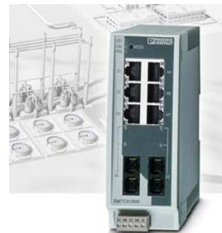
Los switches pueden utilizarse en la zona Ex 2 según ATEX e IECEx y disponen de las homologaciones para la construcción de embarcaciones GL/DNV, ABS, LR, BV y RINA. El rango de temperatura ampliado de -40°C a 70°C y la fuente de alimentación redundante permiten además el uso bajo condiciones ambientales adversas. Para una tasa de transferencia de datos se dispone de las variantes con Gigabit en la serie 2300.
