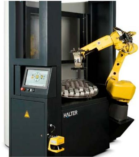
El Halter LoadAssistant integra un robot CNC para la carga y descarga de piezas en los tornos CNC y centros de mecanizado. Se ha diseñado específicamente para empresas de tamaño pequeño y medio con necesidad de una fácil automatización. Su mínimo tiempo de preparación hace que sea rentable incluso para series pequeñas.
