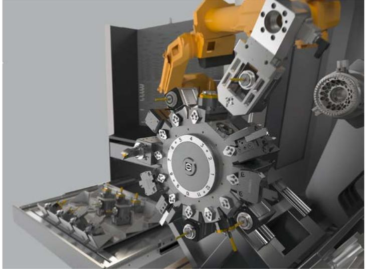
significativamente la velocidad de arranque del material. Las herramientas están sujetadas con una fuerza de 50 kN - la interfaz es extremadamente rígida, lo que permite mecanizar incluso materiales muy resistentes.
