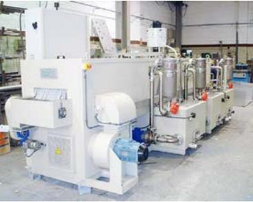
LCB / DC / LCA de Bautermic son máquinas tipo túnel continuo que permiten infinidad de tratamientos, ideal para trabajos en serie que requieran altas producciones. Las piezas son colocadas directamente sobre la cinta transportadora, en cestas o soportes especiales y se descargan en el extremo opuesto. La principal característica de este tipo de lavadoras es que permite la realización de tratamientos múltiples y está indicada para producciones medias y altas.
