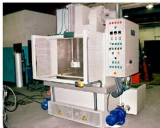
Se fabrica en tres versiones; lavado, lavado + secado y lavado + enjuague + secado.
