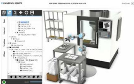
Universal Robots, especialista en robótica colaborativa, continúa abordando la brecha de habilidades de automatización con su nueva aplicación, la plataforma Application Builder, que facilita la configuración y el despliegue de las células robóticas a la vez que aumenta el conocimiento y las capacidades de los robots.
