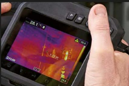
LCD display de 4", resistente a rasguños
