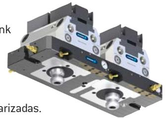
Las mordazas de sujeción Schunk Tandem KSP plus de actuación neumática, pueden unirse directamente al sistema de cambio rápido de palés Vero-S de Schunk, a través de placas base estandarizadas.
