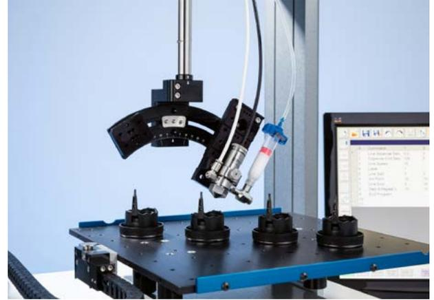
La serie RV cuenta con un software de dosificación especial y una cámara CCD integrada que ofrece una programación intuitiva para una rápida configuración, desde los patrones de dosificación más sencillos hasta los más complejos, en las partes que requieren un cabezal de dosificación rotatorio.
