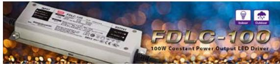
Con el fin de cumplir con las demandas del mercado de focos de iluminación Mean Well lanza la serie FDL-100. Este producto está diseñado en modo de potencia constante, con un rango de entrada desde 180 hasta 295 Vca y de salida desde 1.300 hasta 3.000 mA. Este tipo de driver (constant power) permite ajustar por potenciómetro la corriente de salida entre 1.300 mA y 3.000 mA ofreciendo 100 W de potencia entre 1.850 mA y 3.000 mA.
