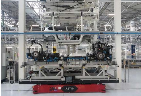
ASTI Mobile Robotics ha desarrollado el vehículo de guiado automático que mejor puede realizar el proceso llamado “boda” en el sector de automoción. Tradicionalmente, el montaje de la parte inferior del coche se realizaba sobre una línea fija y continua de rodillos. Al final de dicho proceso, la parte inferior del coche (powertrain) se unía con la parte superior (carrocería) en un punto llamado “boda” o “matrimonio”.
