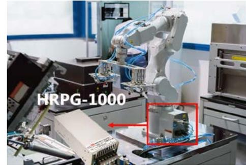
La principal característica de la serie HRPG-1000 es que comparte el mismo mecanismo, dimensiones y modo de funcionamiento que la HRPG-600, lo que permite poder reemplazar la fuente de alimentación de 600 W por la de 1000 W sin modificar el espacio asignado en la instalación.
