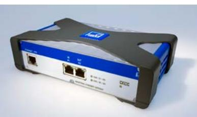
El módulo de pasarela QuantumX CX27C se integra al sistema modular de adquisición de datos QuantumX. Ofrece a los ingenieros la máxima flexibilidad para realizar ensayos de sus aplicaciones, con integración simultánea de hasta 199 sensores con Profinet IRT en tiempo real. QuantumX CX27C es la opción ideal para obtener resultados rápidos incluso en bancos de ensayos altamente automatizados,
