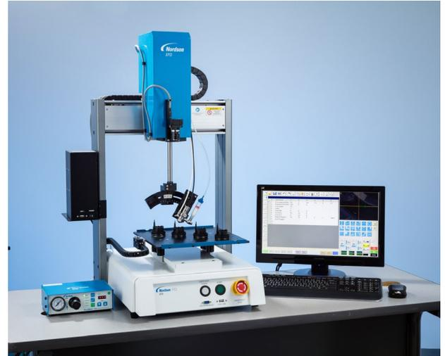
La serie RV cuenta con un software de dosificación especial y una cámara CCD integrada que ofrece una programación intuitiva para una rápida configuración, desde los patrones de dosificación más sencillos hasta los más complejos, en las partes que requieren un cabezal de dosificación rotatorio.
