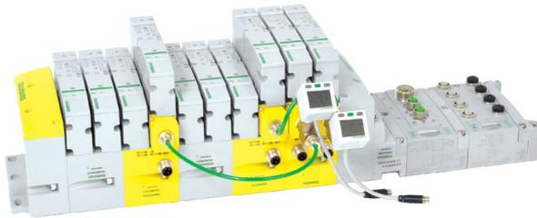
Las funciones de seguridad de zonas permiten el aislamiento de hasta 3 zonas de seguridad en una máquina desde un islote de distribución.
