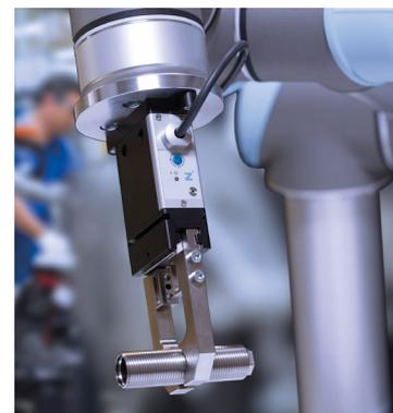
El accionamiento es muy sencillo: se puede accionar la pinza como una válvula mediante puertos de E/S o se puede accionar la versión con IO-Link. Ambas versiones, además, pueden integrarse fácilmente en cuanto a su control.
