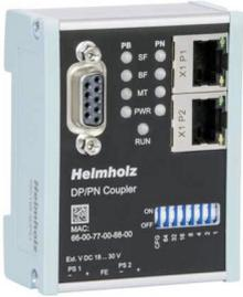
Con el acoplador DP/PN se puede conectar Profibus a Profinet fácilmente. Permite transmitir datos entre un máster de Profibus y un controlador Profinet. El tamaño máximo de datos transmitidos es de 244 bytes, tanto para los datos de entrada como para los de salida. El acoplador DP/PN de Helmholz se configura mediante un archivo GSD en el lado de Profibus y un archivo GSDML en el lado de Profinet. No se requiere ningún otro software de configuración.
