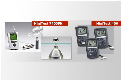
Los equipos de medición de espesor de pared de Elektro-Physik permiten mediciones no destructivas de materiales de hasta 500 mm y sobre superficies con temperaturas de hasta 350°C. Dos sistemas de medición: distancia entre una bola de referencia y la punta del sensor y medición de espesores por ultrasonido.
