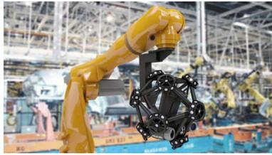
Esta innovación aportará automatización en los procesos de producción de escaneado tridimensional sin renunciar a la velocidad de escaneo, la precisión y la resolución tan excepcionales a los que nos tienen acostumbrados los sistemas de escaneado 3D manuales de Creaform.
