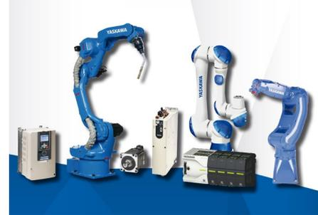
En lo que se refiere a la gama GP de manipulación general destacar que son robots compactos de 6 ejes que ofrecen una alta velocidad y una carga útil de 7, 8, 12 y 25 kg.
