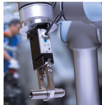
El accionamiento más sencillo: se puede accionar la pinza como una válvula mediante puertos de E/S o se puede accionar la versión con IO-Link. Ambas versiones, además, pueden integrarse fácilmente en cuanto a su control.
