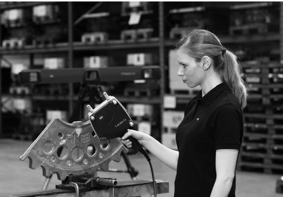
T-Scan se presenta como el equipo de mano de escáner láser de Zeiss, combinado con un sistema de seguimiento y un palpador. Gracias a la gran versatilidad de este equipo y su sencillo manejo, permite realizar mediciones en cualquier entorno o tipo de pieza. Su diseño ergonómico y su capacidad portátil permiten obtener una eficiente digitalización incluso de objetos de gran tamaño. Además, gracias a su palpador adaptado consigue una sencilla medición de puntos individuales.
