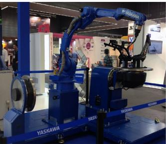
Con su brazo largo, el robot Motoman MA2010 de 6 ejes y alta velocidad ofrece un alcance excepcional (máximo 2.010 mm) y una carga útil de 10 kg. Con posibilidad de utilizar una antorcha de soldadura pesada, permite recorrer amplias trayectorias en utilajes o piezas de trabajo. El robot Motoman MA2010 de Yaskawa ha sido especialmente desarrollado para la soldadura
