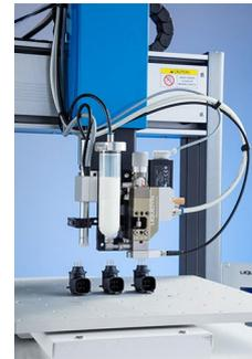
Nordson EFD presenta una serie de sistemas dosificadores neumáticos sin contacto. Las válvulas P-Jet y P-Dot y los controladores V100 bombean fluidos de baja y alta viscosidad con gran precisión y repetición. Están diseñadas para ser utilizadas en diversos tipos de aplicaciones y múltiples industrias, incluyendo la industria automotriz, electrónica, aeroespacial y médica.
