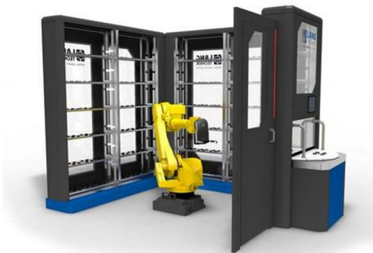
Robo-Shelf es un sistema constituido por un robot articulado con una capacidad de carga de 60 kg incluyendo el palé.
