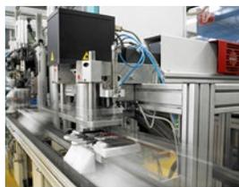
Alta velocidad de marcado y potencia del láser: la SpeedMarker CL destaca por su alta velocidad de marcado. Con la tecnología láser galvo integrada, consigue velocidades punta de más de 400 caracteres por segundo. Gracias a su velocidad es ideal para el marcado de piezas móviles, como en cintas transportadoras (marcado al vuelo). Además, la alta potencia del láser de hasta 200 Watios permite usar el láser SpeedMarker CL tanto para grabar como para cortar con láser.
