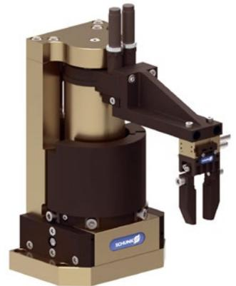
Gracias al control forzado que un rodillo de levas ejerce sobre el movimiento del cilindro vertical y del accionamiento rotatorio, ambos se activan más rápidamente. De este modo, se reduce significativamente el tiempo de ciclo en comparación con las unidades rotatorias y de elevación convencionales.
