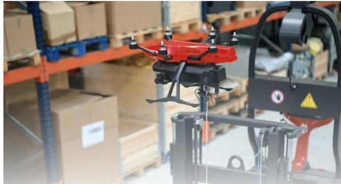
Los drones pueden facilitar el trabajo de inventario en el futuro. Linde Material Handling ha desarrollado Flybox, un prototipo de un dron de inventario. El suministro de energía y el control de esta nave se garantiza mediante el vínculo del dron con el apilador automatizado L-Matic.
