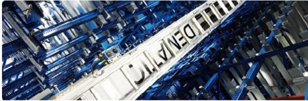
Diseñados para optimizar el rendimiento, los almacenes automatizados Miniload de Dematic manejan cajas y bandejas, enviándolas a los operarios o a los sistemas de transporte.
