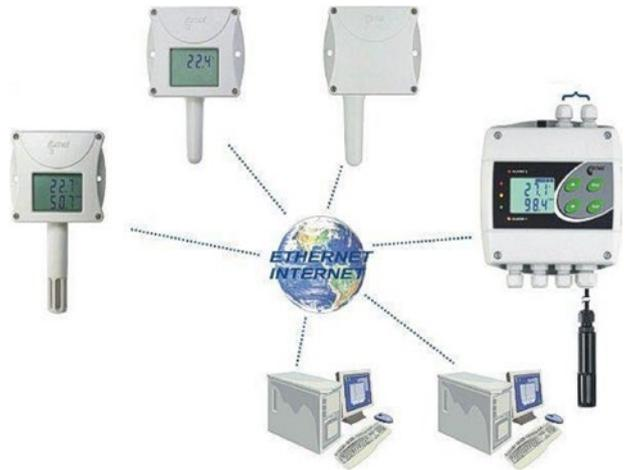
Los transmisores Comet con comunicación Ethernet están diseñados para realizar la medición de temperatura, presión barométrica, humedad relativa, punto de rocío, humedad absoluta y específica (según modelo).
