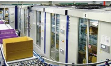
El Kardex Remstar Horizontal es un carrusel horizontal automatizado, especialmente indicado para almacenaje de materiales de pequeña o mediana dimensión. Se puede integrar en circuito de preparación de pedidos y aumentan la productividad. Ha sido instalado con éxito en una gran variedad de proyectos con una altura de hasta 4,10 metros y una carga total de hasta 60 t por módulo.
