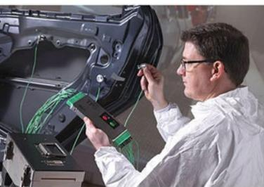
El AutoPaq de Datapaq revoluciona los procedimientos de perfilado de temperatura en el sector de la automoción gracias a sus veinte canales y gran memoria para múltiples pasadas.
