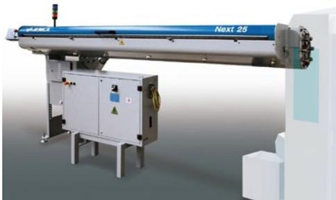
El Next 25 es una solución innovadora diseñada para tornos multihusillo que combina un manejo extremadamente sencillo y altas prestaciones. Puede trabajar barras de 3 a 25 mm, en guías específicas y hasta a 10.000 rpm.
