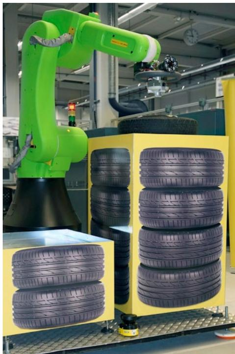
El objetivo de los robots colaborativos es ayudar a las personas, no reemplazarlas. El robot se encarga del trabajo duro, las tareas repetitivas, los trabajos que requieren mayor precisión, mover cargas, y mantener unos niveles de calidad y homogeneidad constantes, mientras que el operario asume las tareas analíticas y las que añaden valor al producto final.
