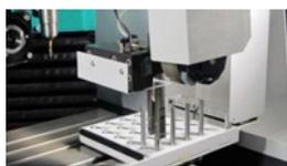
Todos los movimientos del cargador se controlan mediante CNC o se accionan neumáticamente, lo cual permite una definición libre tanto de la paleta como del sistema de sujeción. El diseño integrado del cargador apenas aumenta el espacio ocupado de la máquina.
