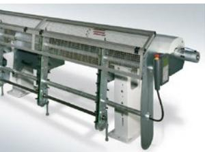
El cargador de barras automático para barras de pequeño diámetro es ideal para tornos de levas o CNC. La tecnología de guiado del Tryton está basada en la utilización de tubos completamente cerrados en los cuales el aceite permite crear el efecto hidrodinámico que centra las barras en rotación: Tecnología Hydrobar. Velocidades de rotación elevadas en toda la gama de diámetros. Barrilete configurable según la capacidad del torno. Rápido cambio de diámetro.
