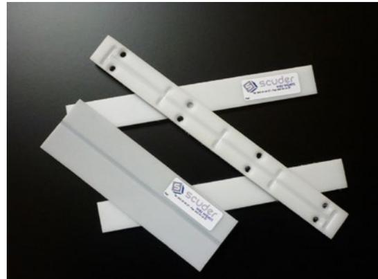
Biplast-V de Scuder es una guía de deslizamiento para la construcción moderna de máquina-herramienta y otro tipo de maquinaria. Está compuesta por láminas de resina acetálica (POM natural), recubierto en la cara del encolado por un tejido sintético especial (STRETCH), formando una unidad inseparable.
