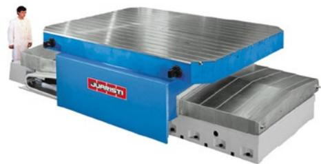
El modelo estándar consta de 2 movimientos: rotación de la mesa sobre el carro (eje B) y traslación del conjunto sobre la bancada (eje V). Opcionalmente se pueden suministrar también sólo con la rotación (eje B).
