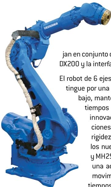
Con los modelos Motoman MH215II y MH250II, Yaskawa presenta dos robots de manipulación de la serie MH. Ambos robots trabajan en conjunto con el nuevo controlador de robot DX200 y la interfaz Profinet MotoLogix mejorada.
