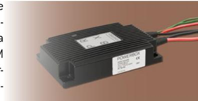
La serie ENA400-M cubre dos tensiones de bus industrial, 24V (18 a 32V) y 48V (35 a 65V). Los productos incluyen protección de bajo voltaje, sobretensión y de voltaje inverso. También el diseño tiene en cuenta el ahorro de energía de la batería, en modo de espera la corriente de entrada es inferior a 1 mA y la corriente sin carga es inferior a 30 mA.
