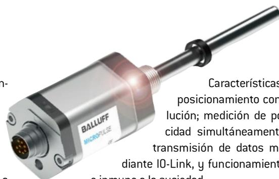
Características principales: posicionamiento con 5 m de resolución; medición de posición y velocidad simultáneamente; medición y transmisión de datos muy rápida mediante IO-Link, y funcionamiento sin contacto e inmune a la suciedad.
