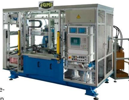
Esta máquina a medida está compuesta por un transfer dial con 6 estaciones de trabajo donde se realizan los siguientes procesos: carga manual de remaches, guías y patas; control de presencia de componentes, remachado automático de dos posiciones y de ejes y finalmente, evacuación automática.
