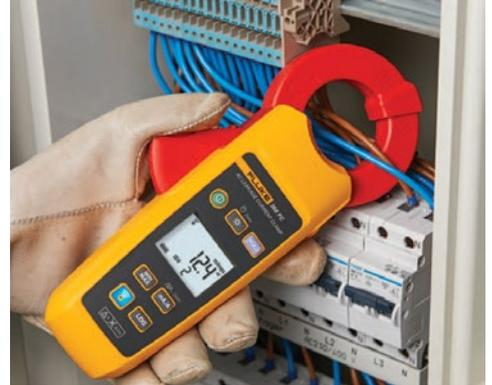
Fluke 368 FC y 369 FC tienen mordazas de gran diámetro (40 mm en el caso de 368 FC, 61 mm en el caso de 369 FC) para adaptarse a conductores de mayores dimensiones. La mordaza está totalmente apantallada para capturar con precisión señales de fuga muy pequeñas, y para minimizar la interferencia electromagnética externa.
