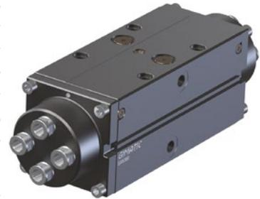
Las pinzas con grado de protección IP 67 de Gimatic están especialmente indicadas en tareas de alimentación y evacuación de piezas en máquina-herramienta, donde las salpicaduras con líquidos refrigerantes y lubricantes, junto con las virutas y partículas metálicas propias de los procesos de mecanización, son un serio problema para la vida efectiva de pinzas que no posean una adecuada protección.
