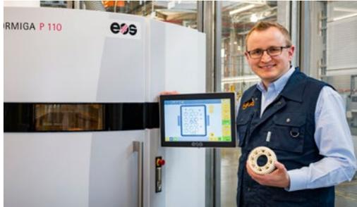
En la industria de la fabricación aditiva, la técnica de sinterizado selectivo por láser (SLS) es uno de los métodos más habituales de impresión 3D. Es posible crear componentes capa a capa con las medidas exactas requeridas y producir componentes muy pequeños y de diseño extremadamente complejo, ya que el láser sinteriza las partículas de polvo con extrema precisión.
