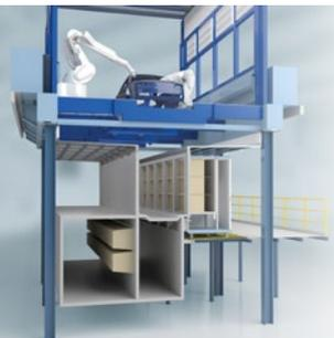
Dürr ha completado su gama de sistemas de separación de exceso de pulverización de pintura en seco con el nuevo sistema de filtrado EcoDry X. EcoDry X es la alternativa al ya establecido y completamente automático EcoDryScrubber. La familia de productos de Dürr se compone de soluciones técnicas diferenciadas para la pintura automotriz en serie, desde automática hasta semiautomática.
