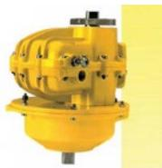
El mecanismo del reductor es enteramente de acero empleando contactos de rodillos, a fin de minimizar pérdidas por fricción y desgaste, para proporcionar una vida máxima. El reductor lleva engrase de por vida, alojado en una caja robusta de fundición de aleación de zinc, completamente sellada. El exterior lleva un tratamiento de superficie resistente a la corrosión a base de esmalte epoxi al horno.
