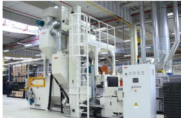
La máquina de túnel CWB 850 4T está diseñada para el tratamiento automático continuo de piezas planas desde 800 mm por altura de 400 mm hasta una longitud infinita con 4 turbinas de 7,5 kW. Se trata de una máquina que permite que los procesos sean más rápidos, eficientes y flexibles para la obtención de piezas de mayor calidad a un costo más reducido.
