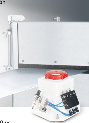
El sistema de lubricación AutoJet L210 es una solución básica y está indicado para lubricantes de baja viscosidad. Utiliza boquillas sin aire y bombas de pistón de alta presión, lo cual genera una fina neblina en el interior del lubricador de chapa proporcionando un máximo ahorro de producto y un entorno limpio y seguro.
