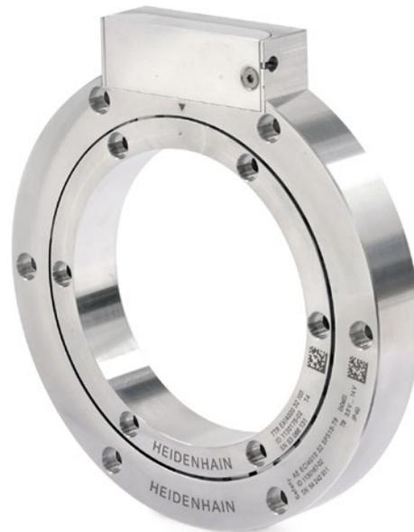
Los ECI 4000/EBI 4000 son aparatos modulares sin rodamiento propio con un tamaño de eje hueco de 90 mm. Pueden sustituir a los accionamientos de correa dentada convencionales para acoplar un sistema de feedback de motor a motores torque. Con un menor número de componentes, estos encoders consiguen mayores prestaciones y permiten un funcionamiento sin desgaste.
