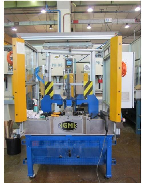
Agme Automated Assembly Solutions desarrolla soluciones a medida para realizar de forma óptima la inserción de muelles en subconjuntos previamente montados de componentes de asientos. Este módulo de ensamblaje está integrado por una unidad especial de torsión de muelle, que también lleva a cabo la comprobación de mano y la inserción del muelle en la pieza montada.
