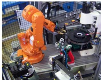
Los principales componentes de esta máquina de montaje de cubo rueda son: alimentadores, cintas transportadoras, dispositivos de selección y pinzado, un robot para la manipulación de las piezas y una mini prensa hidráulica Agme que integra un sistema de aseguramiento de calidad. Este sistema garantiza que el proceso se realice de forma correcta y se consiga una total homogeneidad de las piezas procesadas con altos estándares de calidad.
