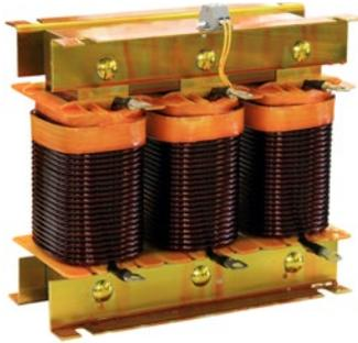
Los transformadores monofásicos o trifásicos son usados como aislamiento eléctrico para la reducción de las perturbaciones de red o para ajustar el nivel de tensión proveniente de la red de distribución. Y los autotransformadores, al tener las bobinas conectadas en serie, no proporcionan aislamiento galvánico, por lo que su función es convertir una tensión a otra, siendo una solución más económica que los transformadores.
