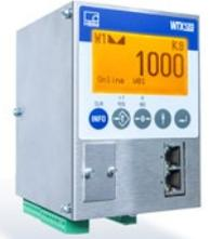
La terminal WTX120 combina las características técnicas esenciales en la electrónica "moderna" de pesaje y una facilidad de uso extraordinaria, y dispone de interfaces industriales normalizadas, como Profinet, EtherNet/IP y Profibus. Con una resolución máxima de 30.000d (pesaje legal: 10.000e), cumple todos los requisitos técnicos y legales.
