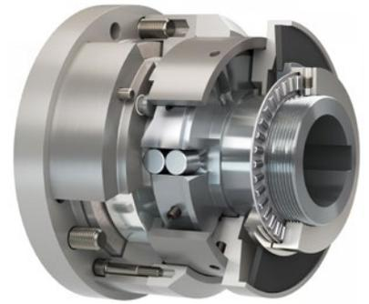
El EAS-reverse es un limitador robusto de par de desacoplamiento que resiste cargas elevadas y que se reacopla automáticamente, característica ideal para los accionamientos a los que no se puede acceder para reacoplarlos.
