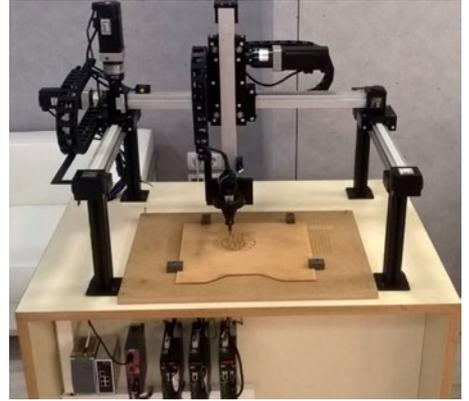
El gantry, cartesiano está orientado para la confección de madera con una fresa, pero si se cambia la herramienta por un láser de CO2 se podrá cortar metal o chapa de forma muy sencilla.
