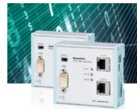
pietarios CAN, incluyendo dispositivos con protocolo SAE J1939, entre otros. Los datos de E/S del dispositivo CANopen® se muestran de forma transparente y libremente configurable en la red PROFINET, por lo que se pueden procesar directamente en el PLC.
