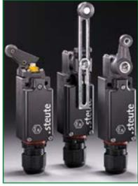
Los interruptores se prueban y certifican de acuerdo con ATEX e IECEx para usarlos en ambientes explosivos, zonas Ex de gas 1 y 2; así como en zonas Ex de polvo 21 y 22. También se pueden utilizar a temperaturas de hasta -60°C. Las carcasas robustas se fabrican de plástico de alta calidad con un refuerzo de fibra de vidrio que es en parte de estructura textil. Además, las tapas de la carcasa se vulcanizan completamente, lo que garantiza que permanezcan cerradas incluso en caso de choque.
