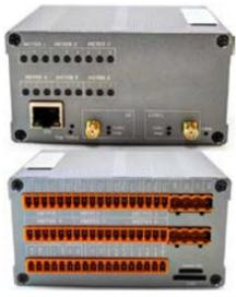
Satel Spain, especializada en soluciones de monitorización y telecontrol, presenta el datalogger SenNet DL172 para aplicaciones de Eficiencia Energética, que integra 18 medidores eléctricos monofásicos o 6 trifásicos admitiendo transformadores de corriente desde 5A hasta 1500A y/o sondas Rogowski desde 100A hasta 5000A.
