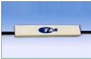
La detección por fibra óptica, que emplea señal y fibras ópticas en lugar de electricidad y cobre, aporta mejoras en seguridad, mayor distancia de transmisión e inmunidad al ruido electromagnético. Los sensores T-09 y T-10 se caracterizan por su resolución de temperatura de 0,1°C, una precisión de 1°C y un rango de -20 a +120°C. La longitud de onda central FGB se sitúa en 1510-1590 nm y el conector puede ser FC/APC o bajo demanda, pudiendo montarse sobre cable de alta tensión.
