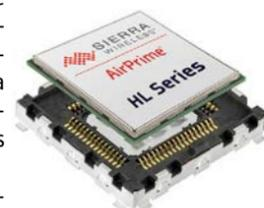
Estos módulos se diferencian por su formato compacto (22 x 23 x 2.5 mm), bajo consumo de energía, elevado rendimiento RF, GNSS (GPS y GLONASS) opcional, cobertura mundial y un rango de temperatura operativa de -40 a +85°C.
