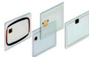
Estos transpondedores se activan mediante un campo electromagnético u ondas de radio enviadas por lectores. Estos son los mismos principios empleados en el intercambio de datos entre tarjeta y lector.
