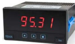
El indicador C40-D es configurable para trabajar con señales de voltajes AC y DC, desde mV hasta 400V, corrientes en AC y DC, desde mA hasta 5A, señales de procesos en 4/20mA y 0/10Vdc, termopares K, J, E, N, L, R, S, B, T y C, sondas de temperatura Pt100 a 2 y 3 hilos, Pt500, Pt1000, Ni100, Ni200, Ni1000, sondas tipo NTC y PTC, medida de resistencias y medida de potenciómetros... en una única unidad.
