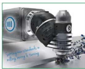
El dispositivo DAS (Dynamics Active Stabilizer) funciona integrado en las fresadoras de SORALUCE y permite optimizar el resultado de las piezas manufacturadas. Esta tecnología tiene capacidad para aumentar activamente la rigidez dinámica de la máquina, incrementar la capacidad de corte y reducir el riesgo de inestabilidad durante el mecanizado. Además, mejora la calidad superficial de las piezas y reduce el riesgo de rotura de las herramientas.
