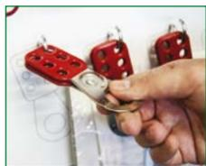
Cuando se aplica correctamente, el bloqueo/etiquetado se reducen los accidentes durante las intervenciones en las máquinas al aislar los puntos de suministro de energía de estas. Los paneles portaherramientas para bloqueo/etiquetado ayudan a distribuir fácilmente los dispositivos de bloqueo y los candados, así como a comunicar procedimientos y permisos de trabajo en curso, proyectos de mantenimiento o aislamientos de energía.
