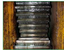
Klüber Lubrication ha desarrollado la grasa Klüberbion LG 39-701 N, diseñada para los fabricantes y operadores de molinetes de anclas, maquinillas, sistemas Jack-up y otros equipos de a bordo con accionamientos abiertos y en contacto permanente con el agua de mar.
