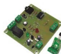
Con un descriptivo manual y esquema en castellano, mediante 6 prácticas se detalla la programación para la lectura de la temperatura de la sonda, el establecimiento de un intervalo de temperaturas, el funcionamiento como termostato, la conmutación y la conexión del relé en modo invierno o en modo verano, o como subordinar la programación al estado de una entrada.
