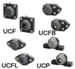
Están fabricados en tecnopolímero de última generación, con base de poliamida, bujes y arandelas de acero inoxidable AISI 304, y rodamientos de acero cromado con capacidad estática de 7,000N a 11,000N y capacidad dinámica de 14,000N a 19,000N.
