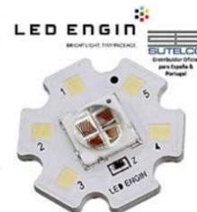
**Leds infrarrojos:** LZ1(1 chip 4x4mm) y LZ4 (4 chip 7x7mm) en 850 y 940 nanómetros.
