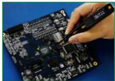
LCR Elite1 es un medidor LCR portable con un diseño mecánico y electrónico que integra un par de pinzas como sondas y un multímetro digital en un equipo compacto, ligero y alimentado a baterías.
