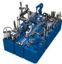
Con cada nuevo componente y pedido priorizado, la celda crea desde cero la coreografía correspondiente. Así, se realiza el seguimiento del proceso mediante sensores, y se envía un informe al sistema de manipulación o a la unidad de control de la planta y al ERP. Las unidades de montaje y los componentes de manipulación de SCHUNK, e incluso la unidad de control del sistema, están conectadas entre sí mediante bus de campo o Ethernet, y construyen un sistema ciberfísico.
