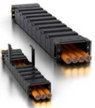
El tubo portacables es resistente a las virutas y evita el daño de los cables protegiéndolos de la taladrina y la suciedad de las áreas de procesamiento. Se trata de un sistema económico que consta de dos partes por cada eslabón de cadena y está fabricado en plástico tribotomizado de igus®. Además de no requerir lubricación ni mantenimiento, la serie R2 es de diseño cerrado y evita la entrada de virutas u otros agentes externos.
