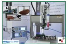
Dado un movimiento rotativo definido del rotor, el producto en el estator es volumétricamente desplazado y se crea el fenómeno del transporte controlado. De este modo, se controla la cantidad de producto desplazada a la cámara de pulverizado que se dispensa satisfactoriamente. Por otro lado, la nebulización precisa y pulverización puede llevarse a cabo de forma continua o puntual.
